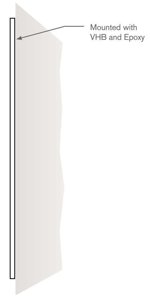
2 SIDE ELEVATION Y.01 Scale: 2" = 1'
